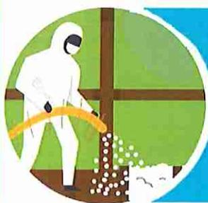
L'isolation des combles perdus (combles non aménageables sous le toit) s'effectue par la pose d'un isolant par soufflage sur toute la surface du sol des combles.
